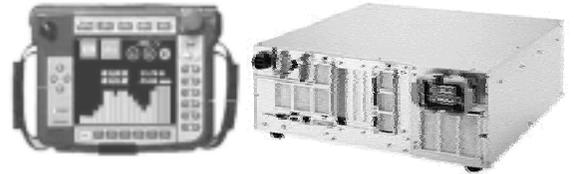
全軸汎用スマートコントローラと、寸法・組み合わせを自在に選べるヤマハ発動機製各種直交・単軸メカとの複合カスタムロボット。事例では、直交3軸ロボットMXYxに、付加軸として単軸YMSを設置。直交ロボット部が、ワークの搬送や組立を、単軸がロードセル対応のライブラリによる良否判定圧入を行う。操作系・モニタ系は多機能ペンダント上に生成し、PLCやその他の単軸コントローラ、盤機器を廃絶した最小制御機器構成となっている。
